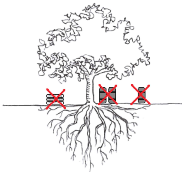
Rysunek 1: Nieprawidłowe składowanie materiałów w obrębie korony i korzeni drzew
